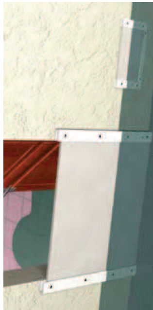
Batardeau de porte et couvercle d'entrée d'air limitant la pénétration de l'eau.
